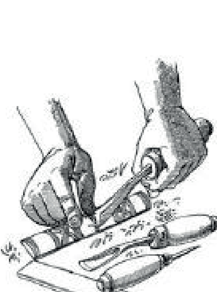
Taglio e decorazione degli elementi lamellari rettangolari (parti dentate e costa centrale del pettine).
