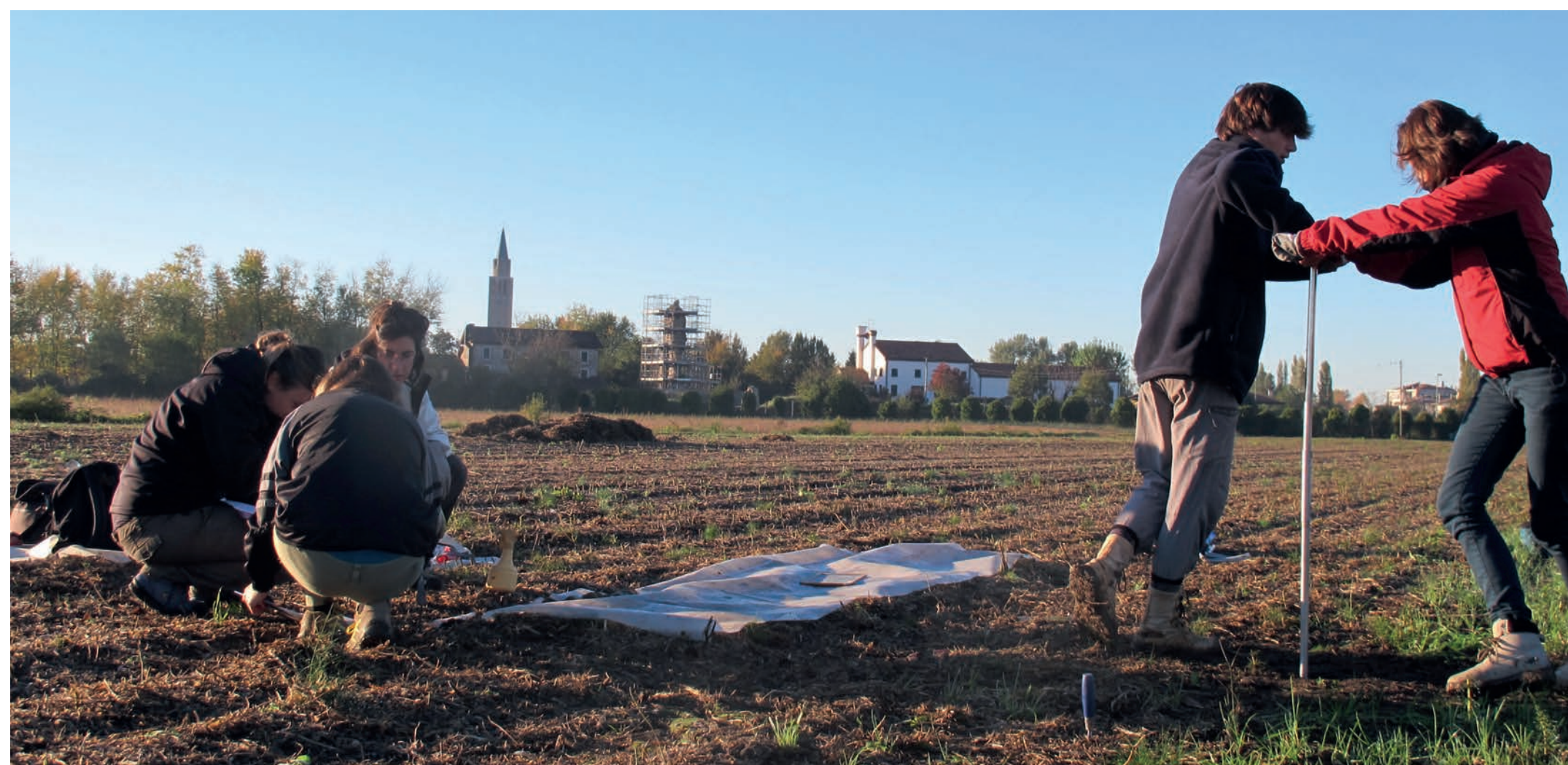
Esecuzione di carotaggi manuali nell’area del sito archeologico Antiche Mura per la documentazione dei sedimenti presenti nel sottosuolo.
